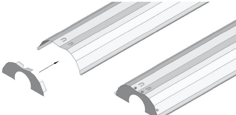
8. obrázok: Montáž koncového dielu
