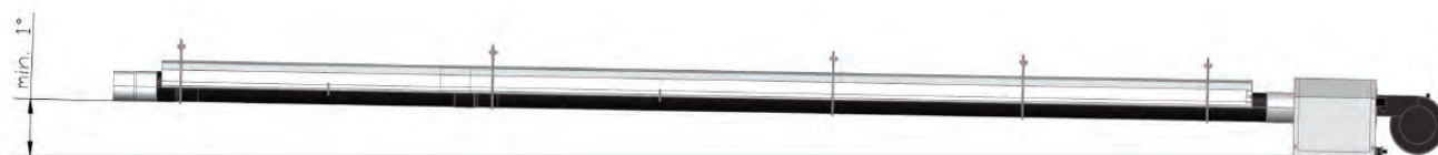
28.obrázok: Minimálny sklon pri inštalácii
