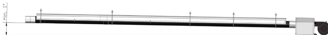
31. obrázok Minimálny sklon pri inštalácii
