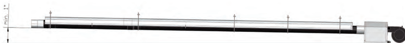
28.obrázok: Minimálny sklon pri inštalácii
