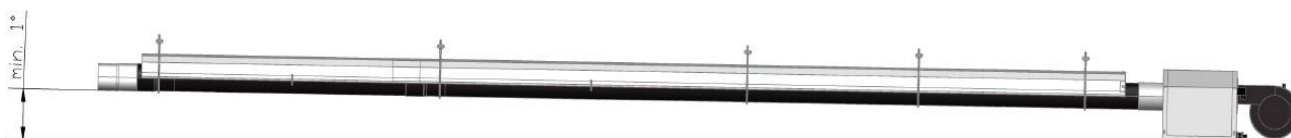
31. obrázok Minimálny sklon pri inštalácii
