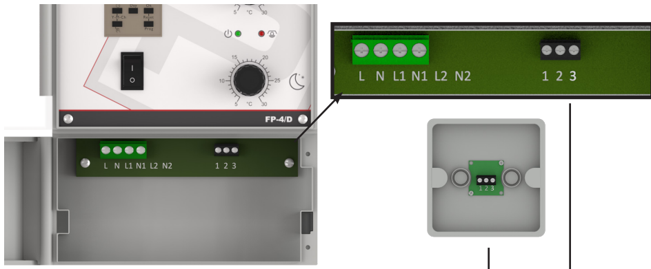
Obrázok č.3: Svorkovnica pre zapojenie vodičov
